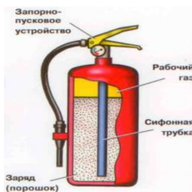
Конструкция огнетушителя порошкового
