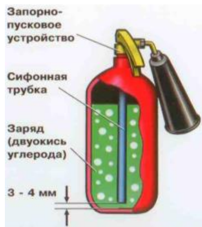
Конструкция огнетушителя углекислотного
